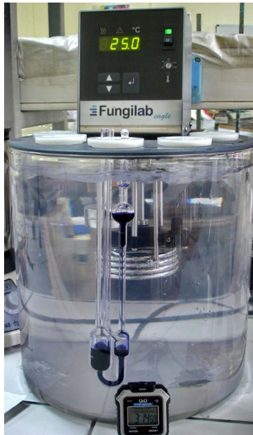
Εικόνα 1. Πειραματική διάταξη για τη μέτρηση του ιξώδους. Διακρίνονται το ιξωδόμετρο τύπου Ubbelohde, το υδρόλουτρο που έχει θερμοστατηθεί στους 25°C και το χρονόμετρο.
