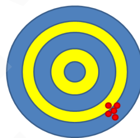
Σειρά μετρήσεων με χαμηλή ακρίβεια, αλλά υψηλή επαναληψιμότητα. Στην περίπτωση αυτή, δεν έχει υπολογιστεί, ή δεν έχει ληφθεί υπόψη το συστηματικό σφάλμα.
