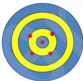
Σειρά μετρήσεων με υψηλή ακρίβεια, αλλά χαμηλή επαναληψιμότητα. Περίπτωση που το τυχαίο σφάλμα είναι μεγάλο.
