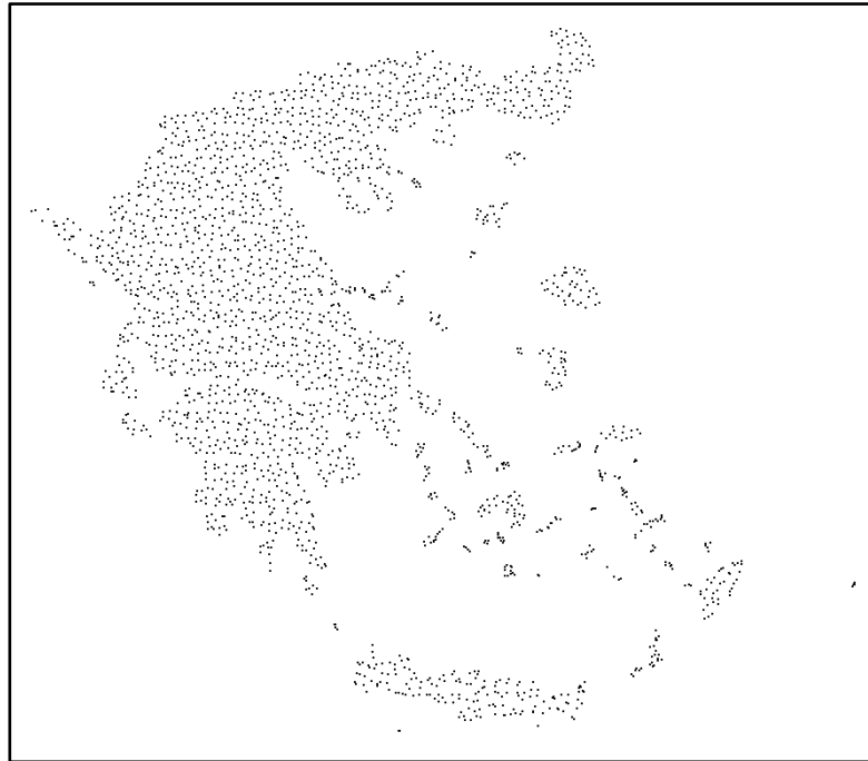
Εικόνα 4. Τα 2470 τριγωνομετρικά σημεία που μετρήθηκαν με GPS στο πλαίσιο του Έργου των μετρήσεων του HEPOS.
