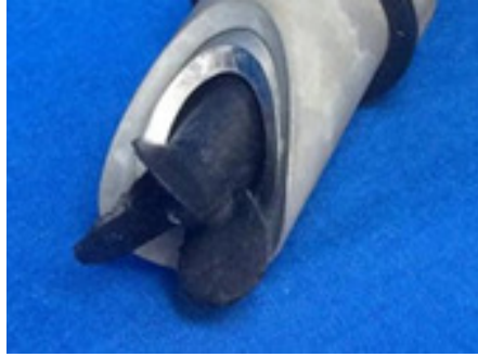
Εικόνα Γ4: Λεπτομέρεια της πτερωτής του μυλίσκου με ίχνη διάβρωσης και απόθεσης αλάτων
