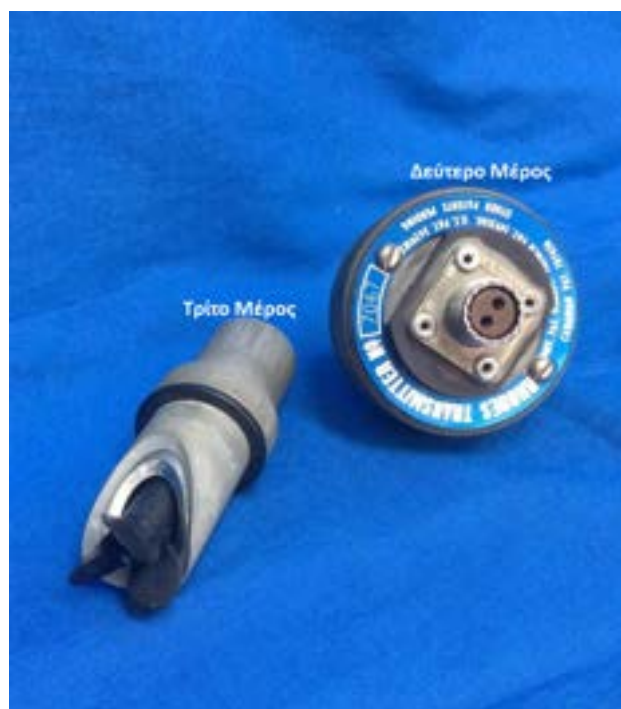
Εικόνα Γ1: Τα κύρια εξαρτήματα του παροχόμετρου μιλίσκου. Αριστερά η περιστρεφόμενη πτερωτή του μιλίσκου και δεξιά ο αισθητήρας της ταχύτητας περιστροφής της πτερωτής
