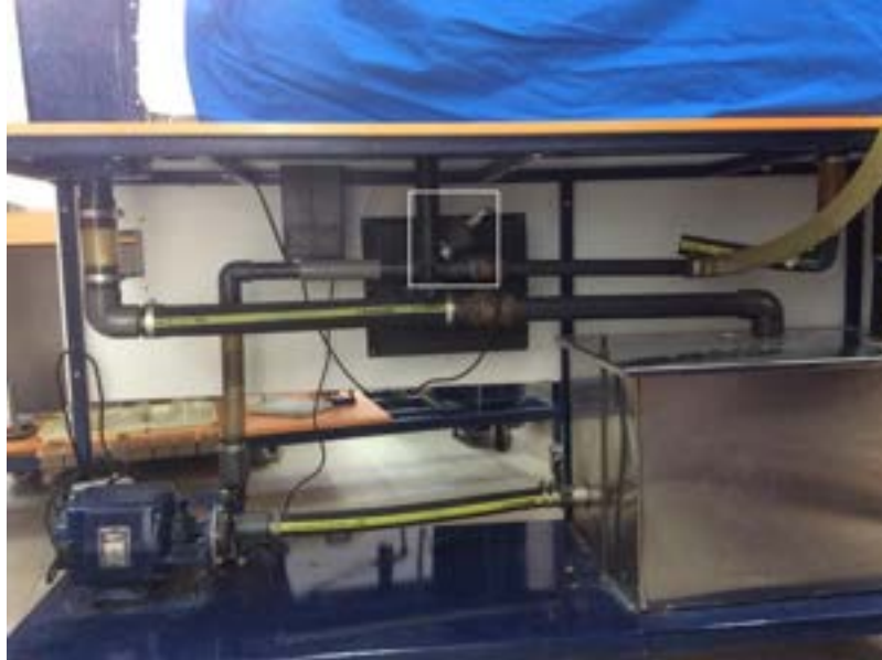
Εικόνα Γ2: Η θέση του παροχόμετρου στην διάταξη
