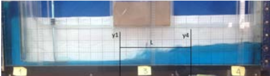
Εικόνα 2: Τυπική φωτογραφία διαμόρφωσης υδραυλικού άλματος στο κανάλι και επισήμανση των κύριων γεωμετρικών χαρακτηριστικών του
