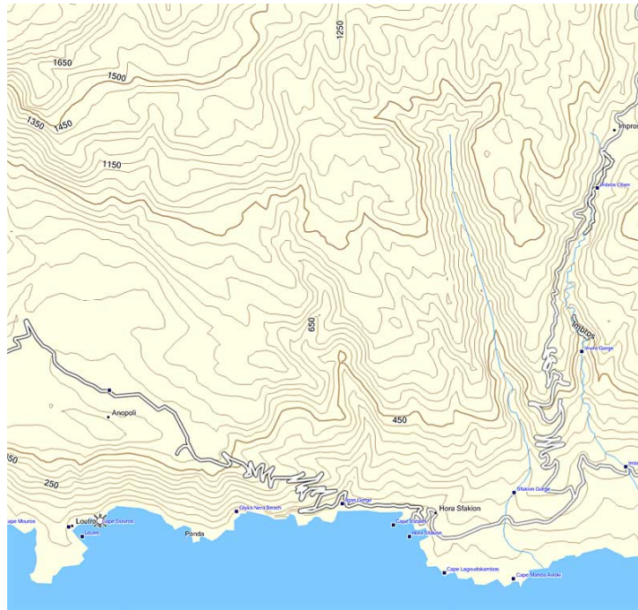
Σχήμα 4: Ισοϋψείς (ισοσταθμικές καμπύλες) σε τοπογραφικό χάρτη.
